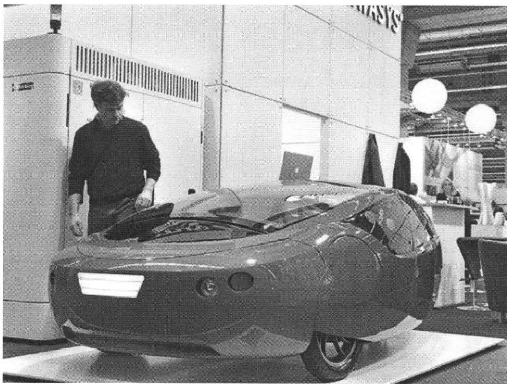
Рис. 5. Автомобиль созданный на 3D-принтере
